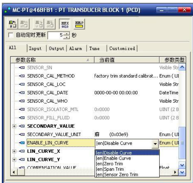
图 6.3 ENABLE_LIN_CURVE 的配置
