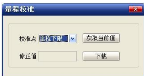
图 5.5 量程校准-校准量程下限
