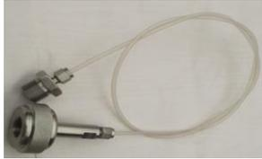
高压气体压力仪表远距离校验仪表与校验器连接使用配送密封件 10 个
