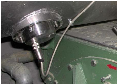
安装在螺旋输送机内用于物料流连续测量的传感器HUMY3000
