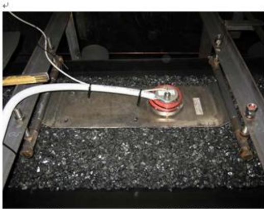
传感器HUMY3000对煤炭物料流进行连续性检测
