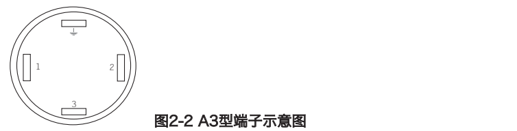
图2-2 A3型端子示意图
